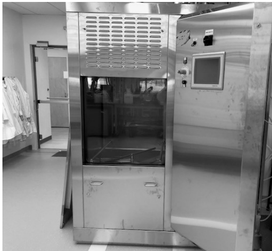
Abb. 1: Einkammer-Reinigungsanlage beim SAT. (Quelle: [-ING])
